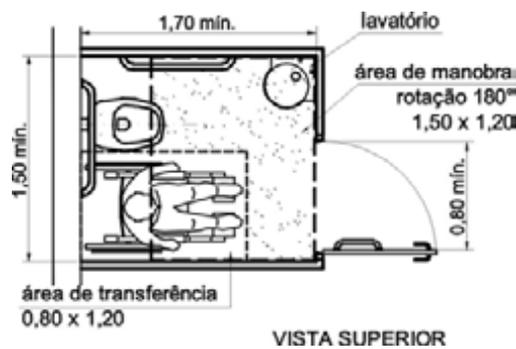
Figura 125 — Boxe para bacia sanitária - Transferência lateral - Exemplo
