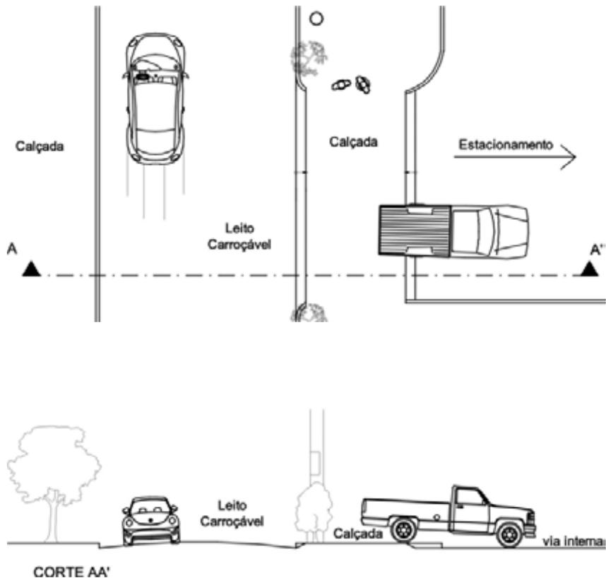
Figura 97— Interferência do veículo no passeio – Exemplo
