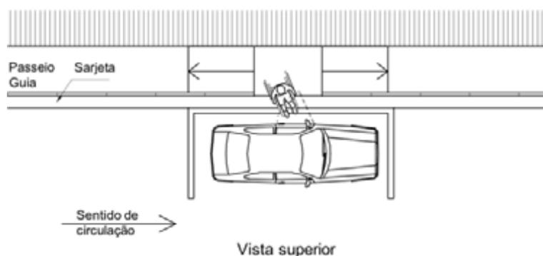
Figura 112 — Vagas para estacionamento junto a passeio rebaixado
