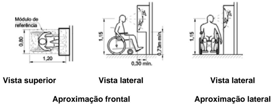
Figura 167 — Máquina de atendimento automático — Exemplo
