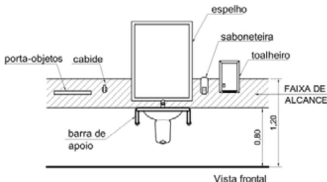
**Figura 141 — Acessórios junto ao lavatório — Exemplo**
