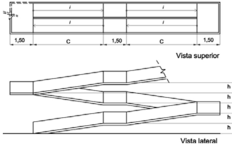
Figura 79 — Dimensionamento de rampas – Exemplo
