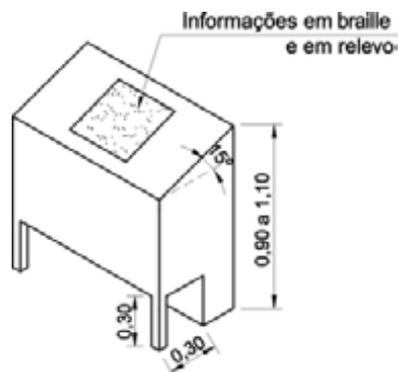
Figura 56— Superfície inclinada contendo informações táteis – Exemplo
