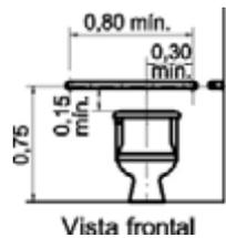
Figura 118 — Bacia sanitária com caixa acoplada
