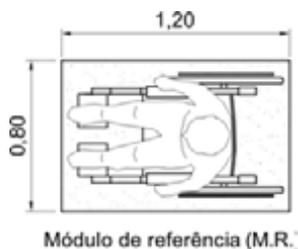
Figura 3 — Dimensões do módulo de referência (M.R.)
