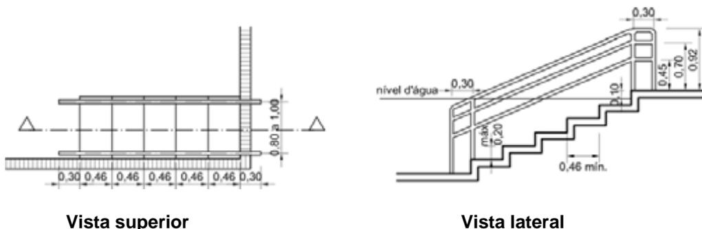
**Figura 156 — Escada submersa — Exemplo**
