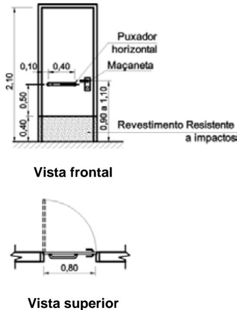
**Figura 94 — Portas com revestimento e puxador horizontal – Exemplo**
